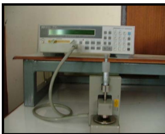
รูป 2.12 เครื่อง LCZ ที่ใช้สำหรับวัดค่าคงที่ไดอิเล็กตริก ( \epsilon_r ) และแฟกเตอร์การสูญเสียในรูปของความร้อน (dissipation factor, \tan \delta )
