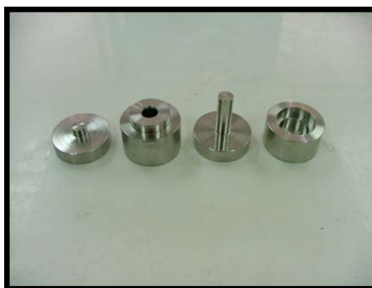
รูป 2.4 แม่พิมพ์โลหะที่ใช้อัดชิ้นงาน
