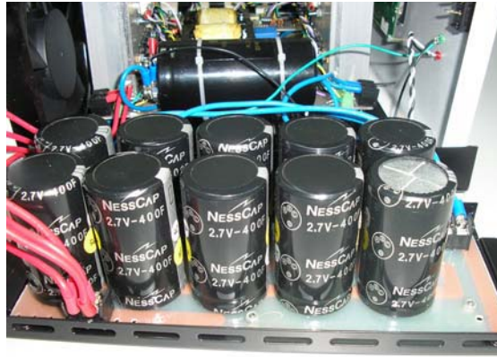
รูปที่ 93 ตัวเก็บประจุความจุสูงขนาดความจุ 400 ฟาห์รตแรงดัน 2.7 โวลต์
