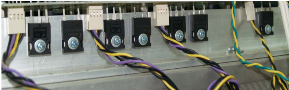
รูปที่ 77 อุปกรณ์ภาคสวิตชิงกำลังที่ได้จัดสร้างขึ้น
