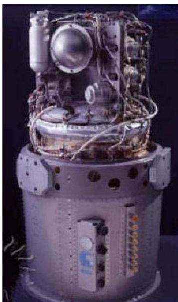
รูปที่ 7 เซลล์เชื้อเพลิงชนิดแอลคาไลน์ขนาด 1.5 kW ที่ใช้นยานอวกาศอพอลโล (ที่มา www.corrosion-doctors.org )
