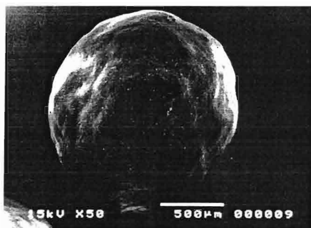
รูปที่ 3 รูป Scanning electron micrographs ของพื้นผิวของ core pellets (A), core pellets ที่เคลือบด้วยชั้นต่าง (HPMC:NaHCO 3 ; 2:8) (B) และเพลเลตที่เคลือบด้วยชั้นต่างและชั้นเคลือบพอลิเมอร์กักเก็บแก๊ส (HPMC:NaHCO 3 ; 2:8, 5 % Eudragit ® RL) (C) magnification 50x
