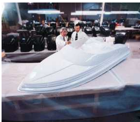
รูปที่ 1.1 ตัวอย่างของชิ้นงานขนาดใหญ่ที่ขึ้นรูปโดยวิธีเทอร์โมฟอร์มมิ่ง (ที่มา : TPI Corporation)
