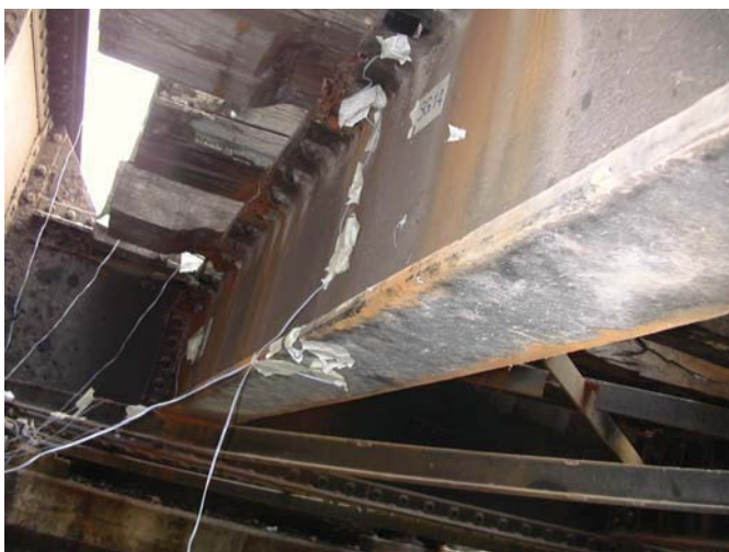
ภาพที่ 4. แสดงตัวอย่างการติดตั้ง Strain gage บนสะพาน
