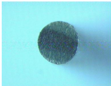
รูปที่ 22 แสดงหน้าตัดของลวดโลหะผสมจำรูป Ti_{50}Ni_{40}Cu_{10} และ Ti_{49}Ni_{51} ที่ผ่านกรรมวิธีการกัดกรด
