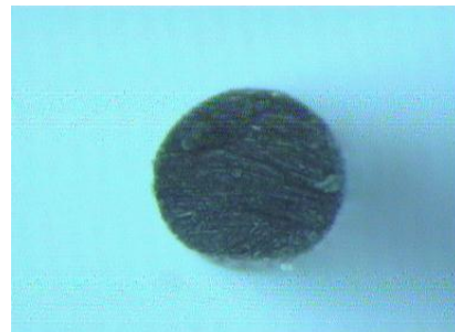
รูปที่ 22 แสดงหน้าตัดของลวดโลหะผสมจำรูป Ti_{50}Ni_{40}Cu_{10} และ Ti_{49}Ni_{51} ที่ผ่านกรรมวิธีการกัดกรด
