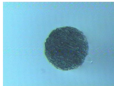
รูปที่ 21 แสดงหน้าตัดของลวดโลหะผสมจำรูป Ti_{50}Ni_{40}Cu_{10} และ Ti_{49}Ni_{51} ที่ผ่านกรรมวิธีการเจียระไน
