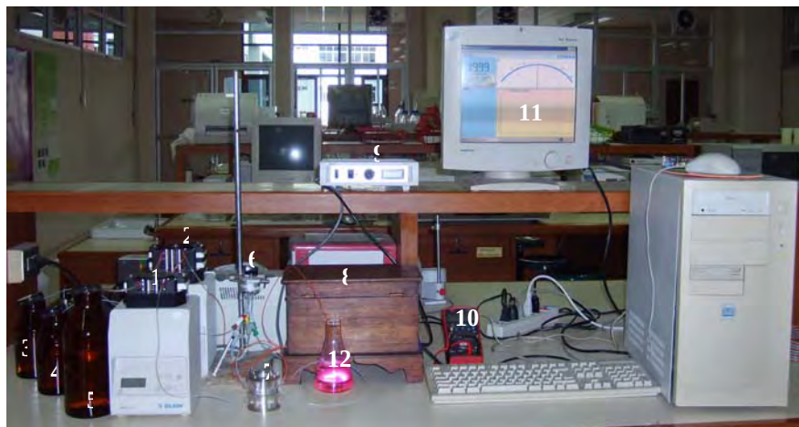
รูป 2.4 ระบบการวิเคราะห์หัลไฟต์ด้วยวิธีเพอร์วาพอเรชันเคมีลูมิเนสเซนส์
