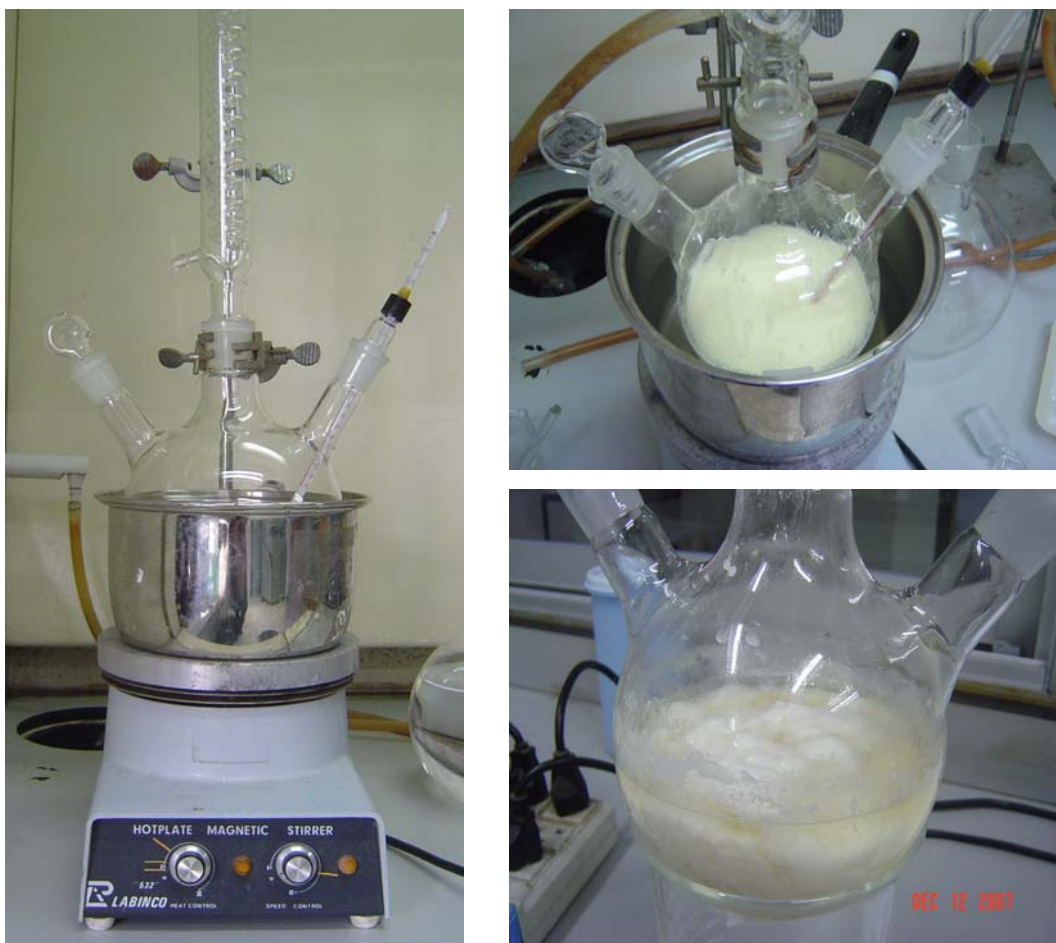
รูปที่ 3.2 ชุดเครื่องมือสำหรับการดัดแปรแป้งดิบด้วยปฏิกิริยาคาร์บอกซีเมทธิเลชัน (ซ้าย) การจัดตั้งชุดเครื่องมือ (ขวาบน) ระหว่างการทำปฏิกิริยา และ (ขวาล่าง) เมื่อเสร็จสิ้นปฏิกิริยา
