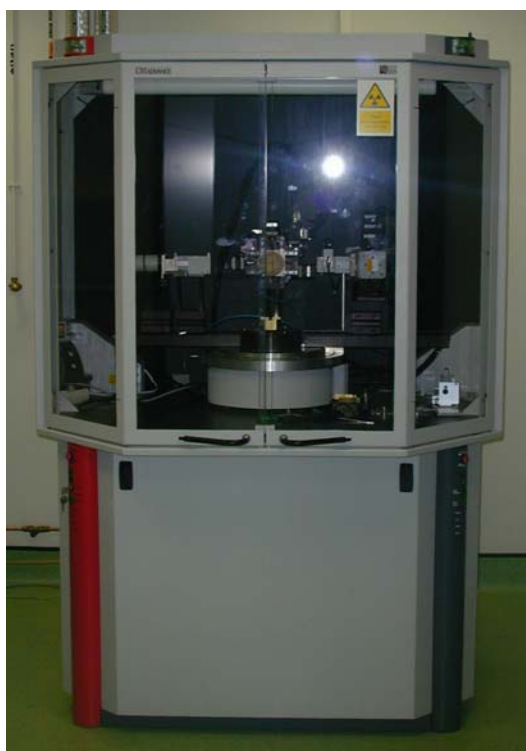
รูป 3.7 เครื่อง X-ray diffractometer รุ่น D8 Advance [39]
