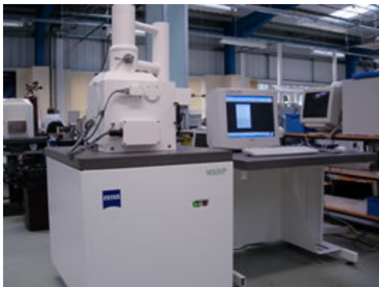
รูป 3.8 กล้องจุลทรรศน์อิเล็กตรอนแบบส่องกราด ผลิตโดยบริษัท LEO รุ่น LEO 1455 VP [40]
