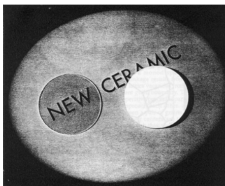
รูปที่ 2.5 รูปถ่ายเปรียบเทียบเซรามิกอะลูมินาไร้รูพรุน (pore-free) และอะลูมินาปกติ [5]
