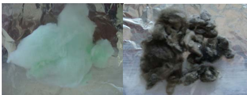
รูปที่ 20 ตัวเร่งปฏิกิริยาเตรียมที่ปริมาณ Ni ร้อยละ 10.0 ก่อนและหลังการแคลไซต์
