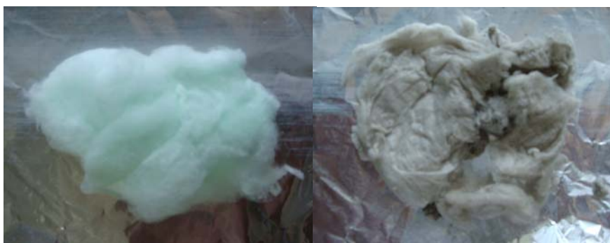
รูปที่ 19 ตัวเร่งปฏิกิริยาเตรียมที่ปริมาณ Ni ร้อยละ 5.0 ก่อนและหลังการแคลไซต์
