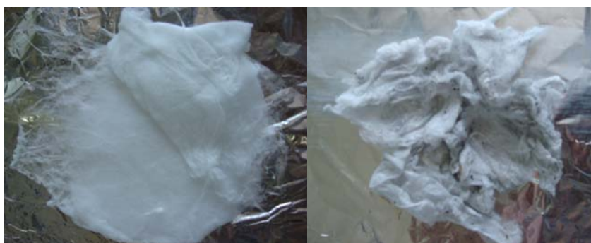
รูปที่ 17 เส้นใยซิลิกา ก่อนและหลังการแคลไซต์
