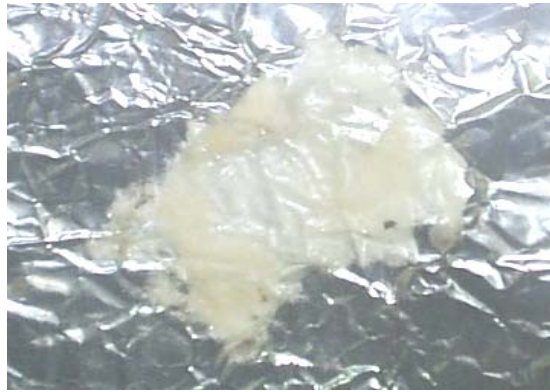
รูปที่ 4 เส้นใยซิลิกาที่ผ่านการสังเคราะห์เป็นตัวเร่งปฏิกิริยา
