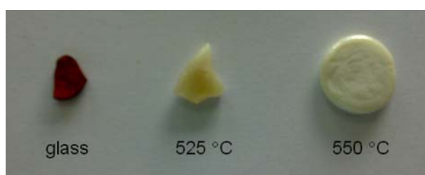
รูป 4.16 ลักษณะทางกายภาพของชิ้นงานแก้วเซรามิกที่ผ่านการหลอมด้วยเบ้าหลอมอะลูมินา และผ่านการ heat treatment ที่อุณหภูมิต่างๆ
