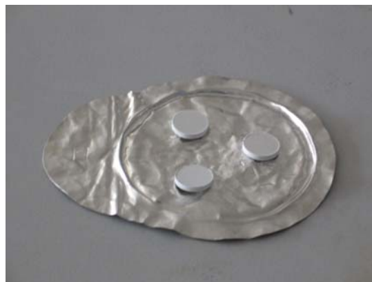
รูป 3.17 ลักษณะการวางชิ้นงานตัวอย่างบนฝาของถ้วยหลอมแพลทินัม
