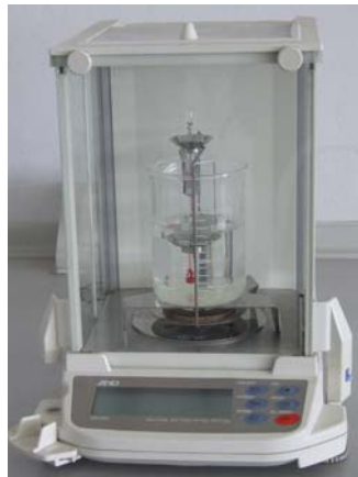
รูป 3.25 เครื่องชั่งระบบดิจิทัล สำหรับวัดค่าความหนาแน่น
