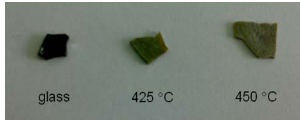
รูป 4.6 ลักษณะทางกายภาพของชิ้นงานแก้วเซรามิกที่ผ่านการหลอมด้วยเบ้าหลอมแพลทินัม และผ่านการ heat treatment ที่อุณหภูมิต่างๆ
