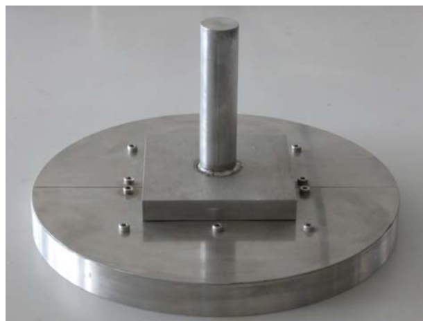
รูป 3.4 แผ่นเหล็กกล้าไร้สนิม (stainless steel plate) สำหรับกดทับน้ำแก้ว
