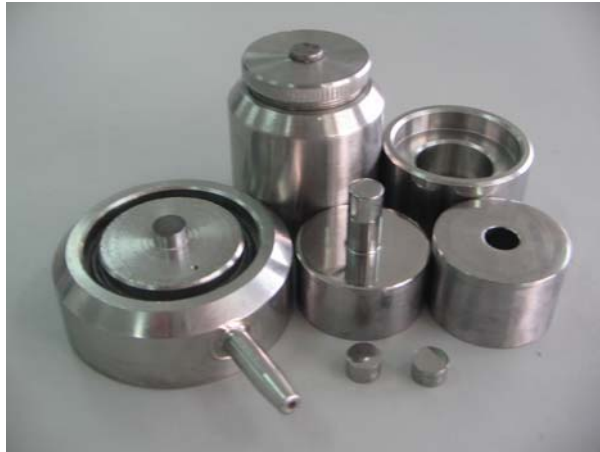
รูป 3.15 แม่พิมพ์ (punch and die) ขนาดเส้นผ่านศูนย์กลาง 1.0 เซนติเมตร
