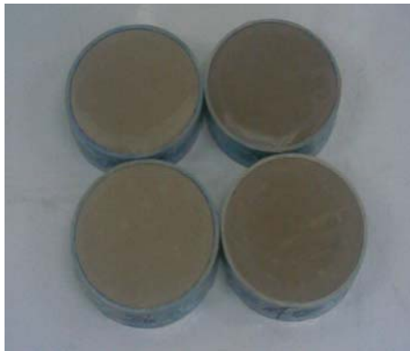
รูปที่ 3 ตัวอย่างทดสอบขนาดเส้นผ่านศูนย์กลาง 63.3 mm ความสูง 20 mm ทำการบ่มที่อายุ 28 วัน
