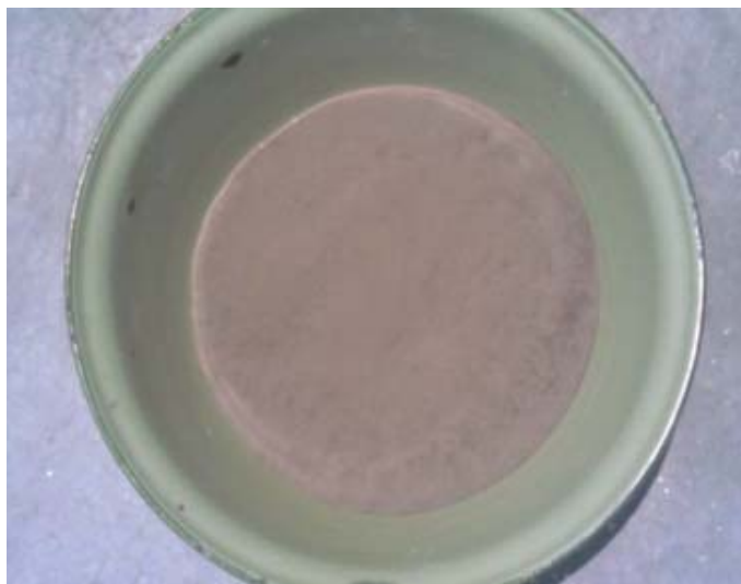
ภาพที่ 3.14 ตัวอย่างดินทรายแป้งที่ล้างตะแกรงเบอร์ 400
