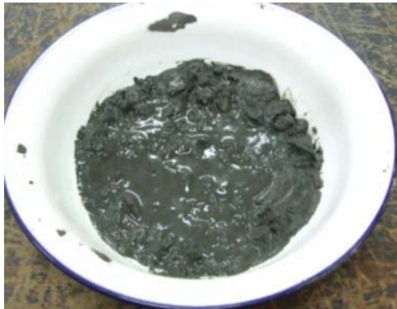
ภาพที่ 3.29 แสดงปริมาณทรายแป้งที่ผ่านตะแกรงเบอร์ 200 และ ค้างบนตะแกรงเบอร์ 400
