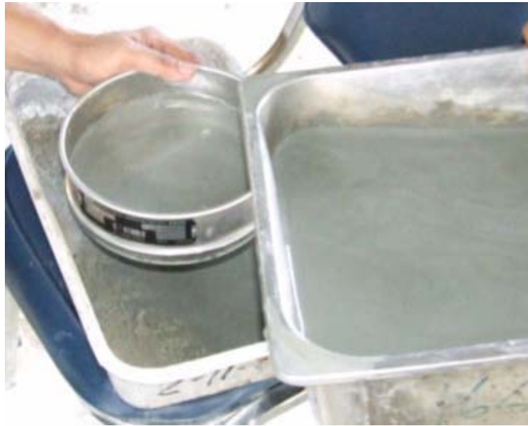
ภาพที่ 3.28 แสดงการร่อนดินเหนียวผสมน้ำผ่านตะแกรงเบอร์ 200
