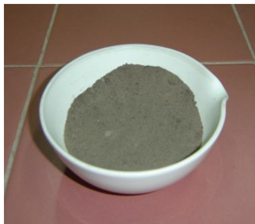
รูปที่ 1 ตัวอย่างทรายแป้งที่ได้จากการร่อนตัวอย่างดินเม็ดละเอียดและคัดขนาดวัสดุที่ค้างตะแกรงเบอร์ 400
