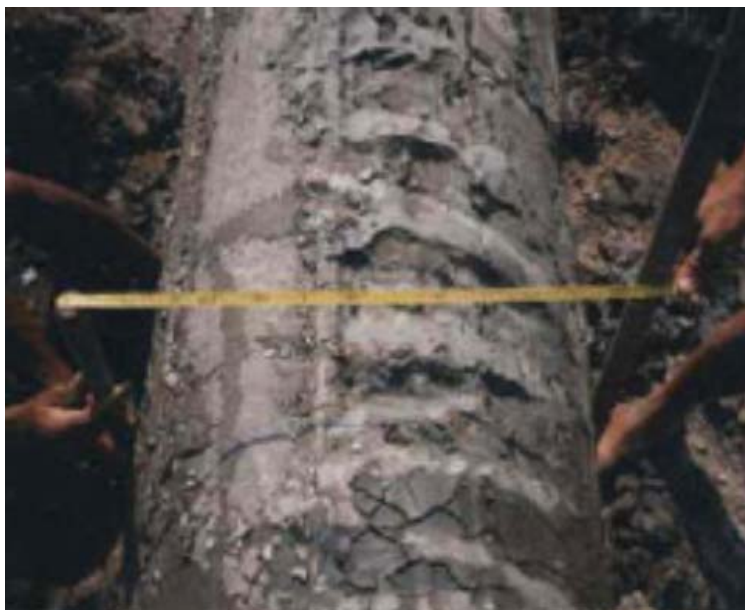
ภาพที่ 2.14 การวัดขนาดเสาเข็มดินซีเมนต์ ช่วงกลางลำต้น
