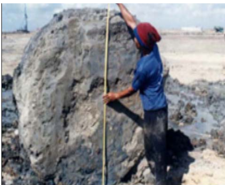
ภาพที่ 2.15 การวัดเส้นผ่าศูนย์กลาง เสาเข็มดินซีเมนต์
