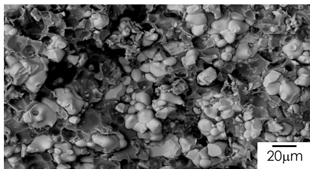
รูป 4.11 ภาพบริเวณรอยหักของวัสดุผสม (backscatter electron signal)
