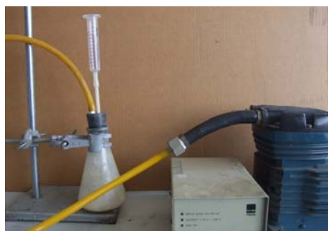
รูป 3.3 ระบบปั๊มที่ใช้ในการขึ้นรูปโดยกระบวนการเทคนิคการขึ้นรูปนี้เรียกว่า เทคนิคชักชั้น
