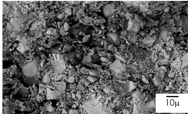
รูป 4.9 ผิวหน้าวัสดุผสมหลังจากผ่าน การตัดเป็นแผ่น (backscatter electron signal)
