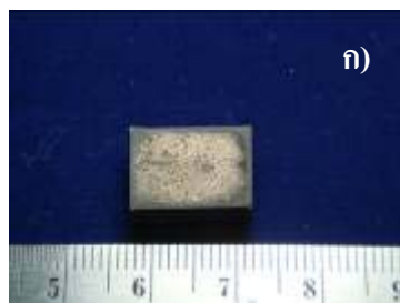
รูปที่ 4.4 ภาพถ่ายชิ้นงานผ่านการทำอะลูมิเนียมไนซิงบน GTD 111 ที่ 900 °C เป็นเวลา ก.) 1 และ ข.) 6.25 ชั่วโมง
