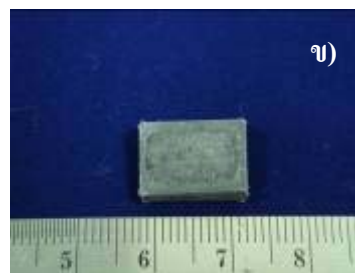
รูปที่ 4.4 ภาพถ่ายชิ้นงานผ่านการทำอะลูมิเนียมไนซิงบน GTD 111 ที่ 900 °C เป็นเวลา ก.) 1 และ ข.) 6.25 ชั่วโมง
