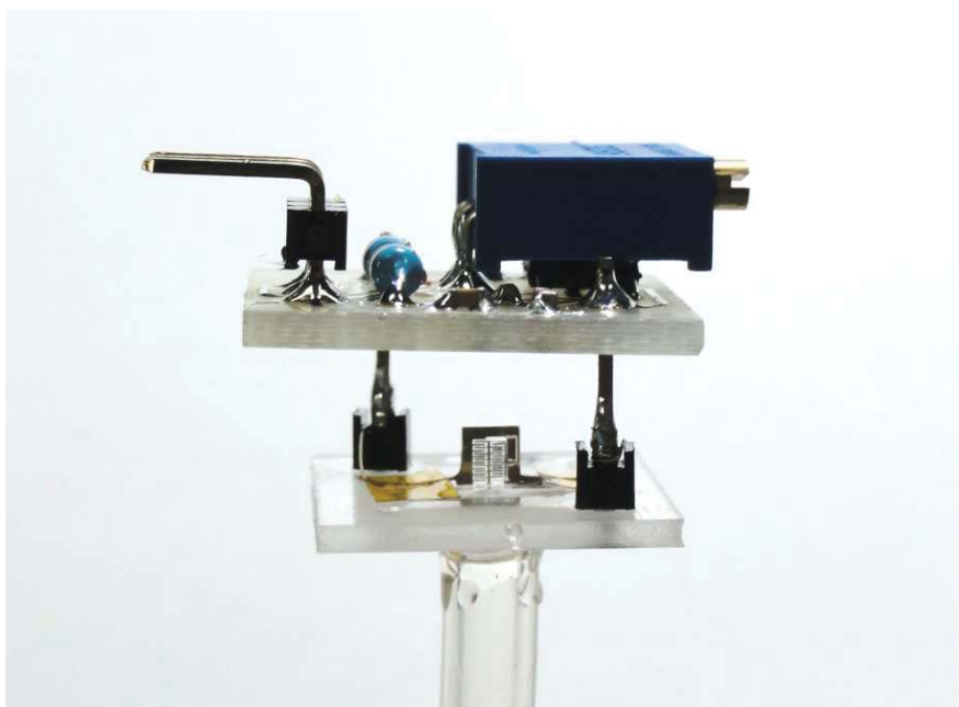
รูปที่ 5.51 ตัวตรวจรู้ความดันที่สร้างเสร็จสมบูรณ์แล้ว
