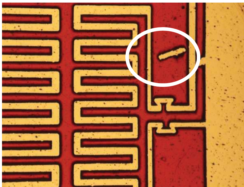
รูปที่ 5.12 ชิ้นงานที่เสียหายเนื่องจากฟองอากาศที่เกิดขึ้นหลังจากการหมุนเคลือบสารไวแสง
