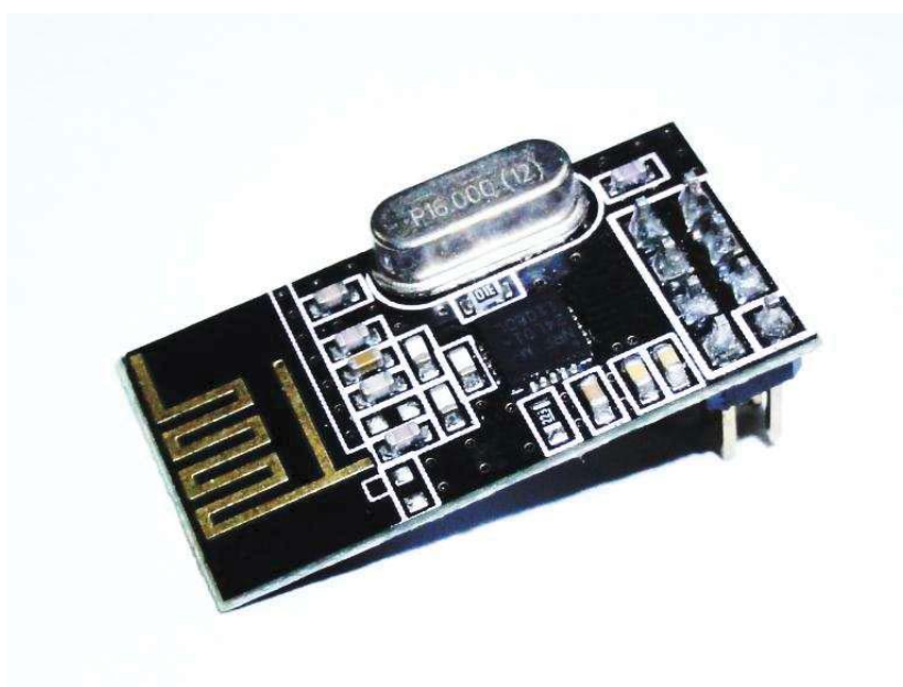
รูปที่ 7.2 โมดูลรับ-ส่งสัญญาณไร้สาย nRF24L01
