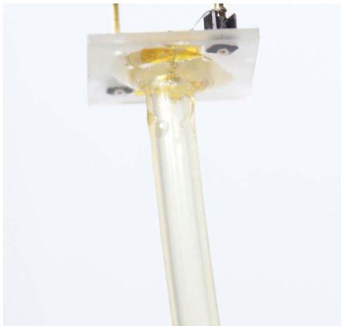
รูปที่ 5.50 การเชื่อมต่อท่อความดันเข้ากับตัวตรวจรู้ความดันด้วยกาวอีพอกซี
