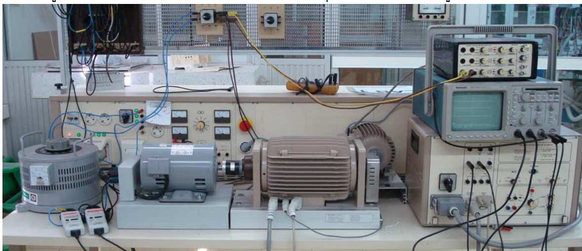
รูปที่ 4.5 ระบบทดสอบมอเตอร์ไฟฟ้าเหนี่ยวนำในห้องทดลอง
