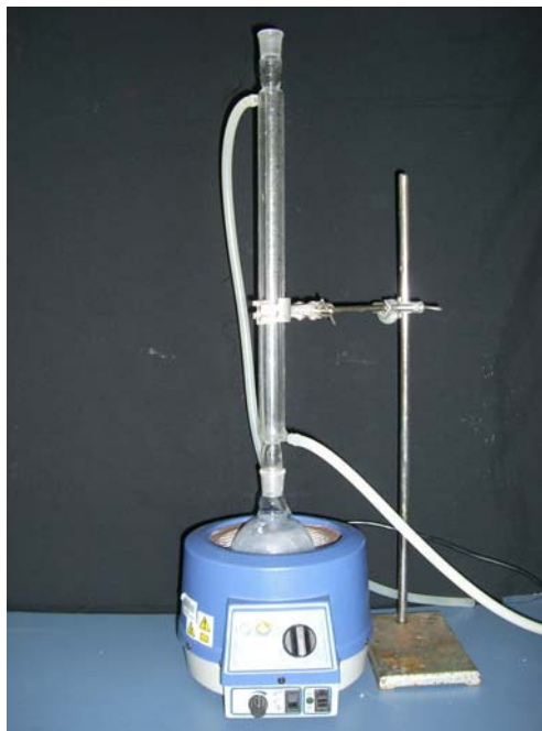
รูปที่ 6 ชุดรีฟลักซ์
