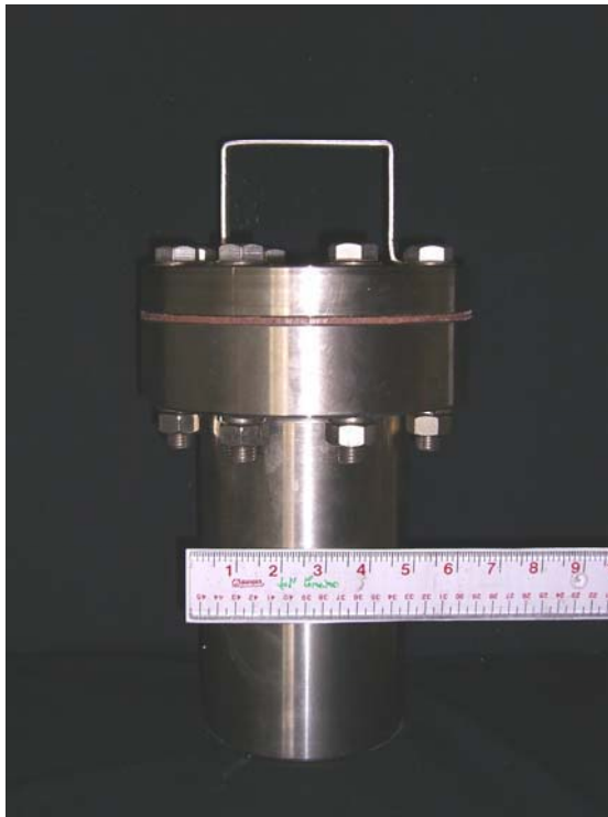
รูปที่ 7 ออโต้เซลล์สำหรับใช้สังเคราะห์ด้วยวิธีไฮโดรเทอร์มอล
