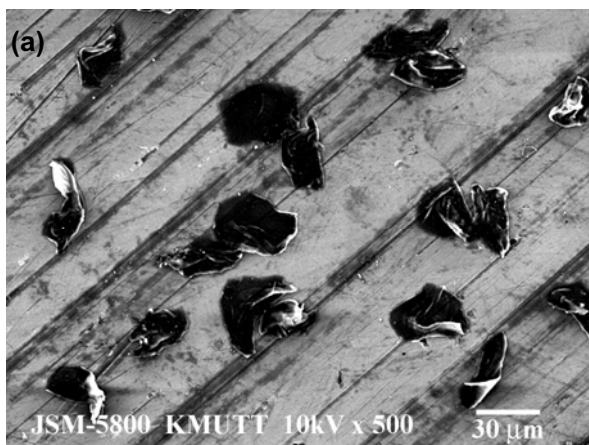
รูปที่ 17 โครงสร้างจุลภาคของอะลูมิเนียมคอมโพสิตที่เติมอนุภาค SiC ที่ไม่ผ่านการเตรียมผิว
