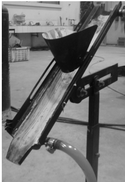
รูปที่ 2 ชุดคูลลิ่งเฟลท (cooling slope)
