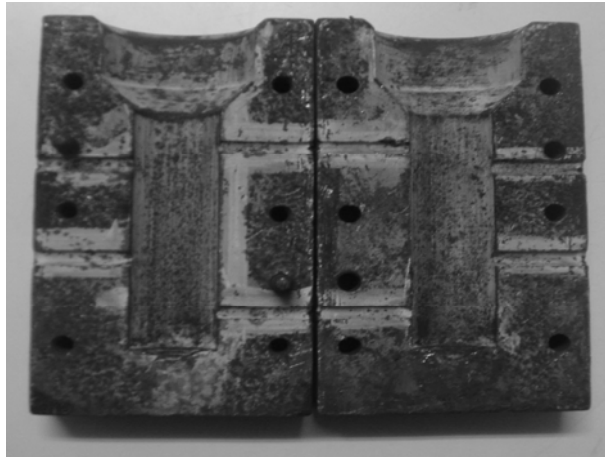
รูปที่ 3 แบบหล่อ (mold)
