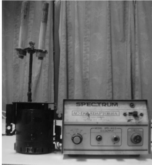
รูปที่ 1 ชุดกวนน้ำโลหะ (mechanical stirrer)
