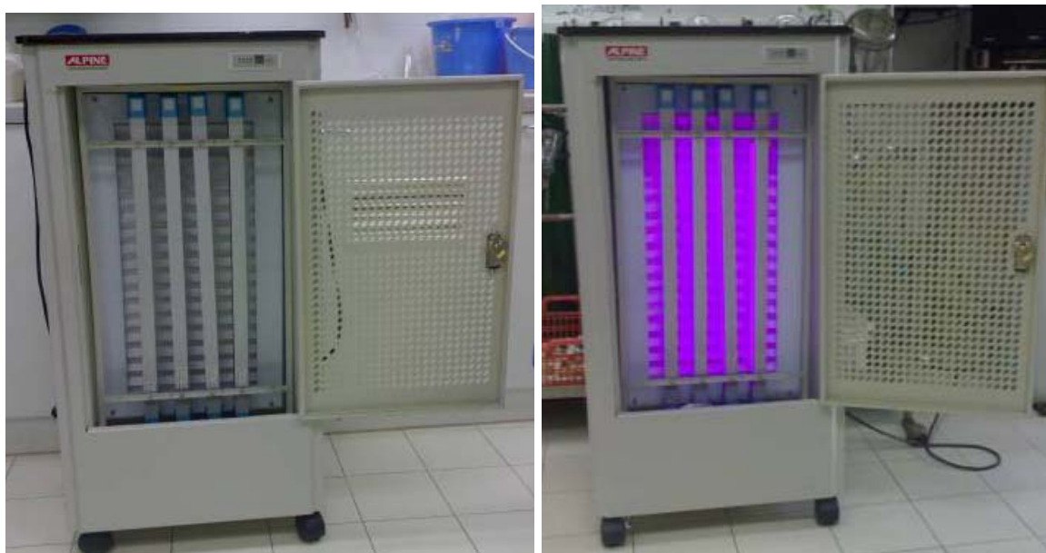
รูปที่ 5 เครื่องฟอกอากาศที่ใช้ปฏิกิริยาโฟโตคะตะไลซิส
