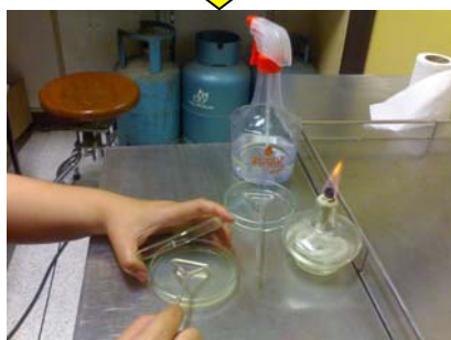
รูปที่ 3 ขั้นตอนการสกัดเชื้อจุลินทรีย์ออกจากแผ่นกรอง HEPA filter
