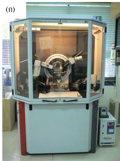
รูปที่ 3.4 (ก) เครื่องเลี้ยวเบนรังสีเอกซ์กำลังแยกสูง (รูปจากศูนย์เครื่องมือวิจัยวิทยาศาสตร์และเทคโนโลยี จุฬาลงกรณ์มหาวิทยาลัย) (ข) แสดงภาพจำลองฐานวางชิ้นงานที่สามารถหมุนได้ 3 ทิศทาง คือ หมุนตามมุม \varphi \psi และ \omega
