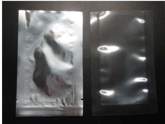
รูปที่ 2 บรรจุภัณฑ์ชนิด Aluminium Laminated Foil (ซ้าย) และ บรรจุภัณฑ์ชนิด Linear Low Density Polyethylene (ขวา)
