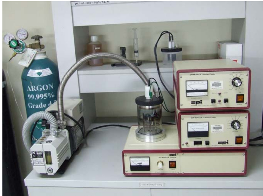
รูป 3.18 เครื่อง sputtering รุ่น JFC-1100E
