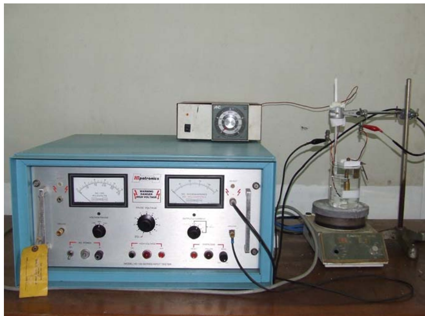
รูป 3.22 เครื่อง HIPOT TESTER รุ่น HD100
