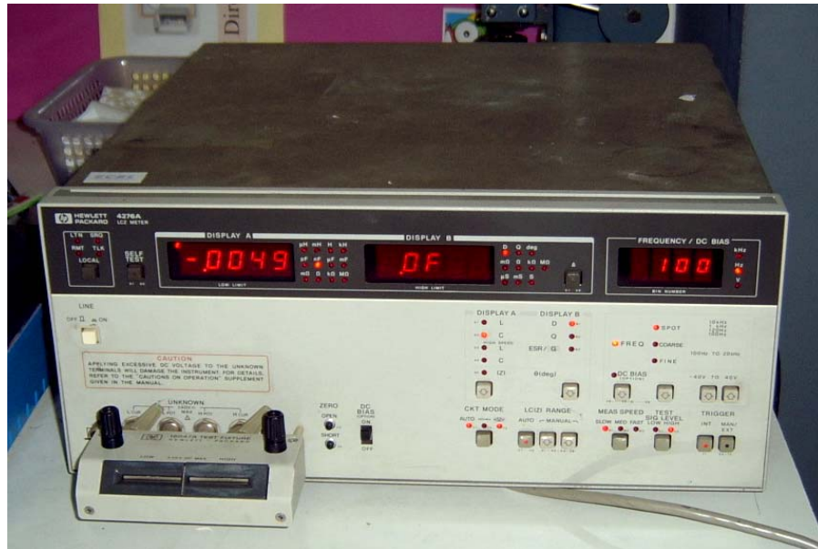
รูป 3.20 เครื่อง LCZ มิเตอร์ รุ่น HP 4276A
