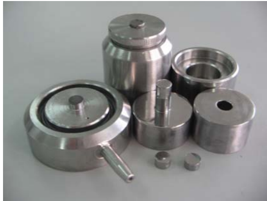
รูป 3.10 แม่พิมพ์ (punch and die) ขนาดเส้นผ่านศูนย์กลางกลาง 1.0 เซนติเมตร
