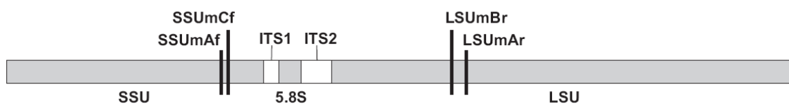
รูปที่ 3. ตำแหน่งของไพรเมอร์ที่ใช้ในการเพิ่มจำนวน DNA บริเวณบางส่วนของ 18S rDNA, ITS และบางส่วนของ 28S rDNA (Krueger et al. 2010)
