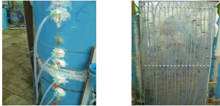
ภาพ 3-9 การติดตั้ง Barometer เข้ากับโมเดล
