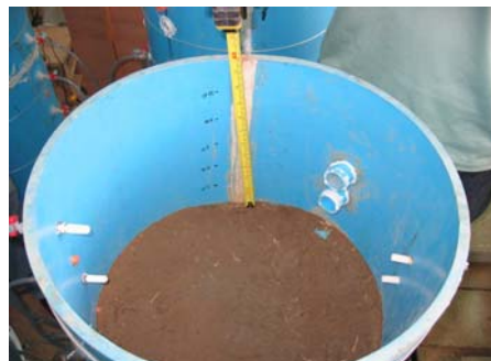
นำดินนาในบริเวณแหล่งชุ่มน้ำกว๊านพะเยา ที่ได้จากการสำรวจมาบรรจุลงในโมเดล ซึ่งในการบรรจุดินในแต่ละชั้นนั้น ต้องบรรจุลงไปทีละ 5 เซนติเมตร จนกว่าจะได้ตามระดับของชั้นดินในแต่ละชั้น
