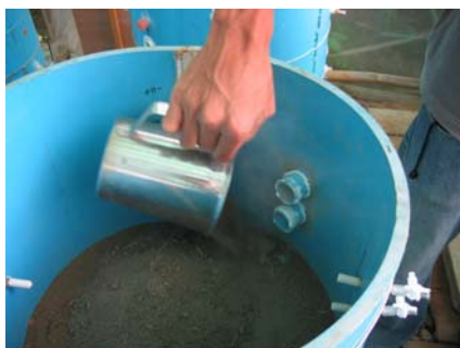
นำดินนาในบริเวณแหล่งชุ่มน้ำกว๊านพะเยา ที่ได้จากการสำรวจมาบรรจุลงในโมเดล ซึ่งในการบรรจุดินในแต่ละชั้นนั้น ต้องบรรจุลงไปทีละ 5 เซนติเมตร จนกว่าจะได้ตามระดับของชั้นดินในแต่ละชั้น
