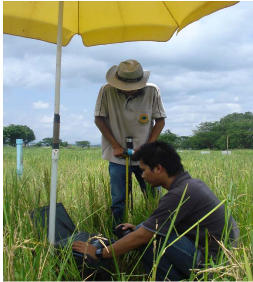
การตรวจสอบค่าความแข็งของดิน โดยใช้ cone mito meter
