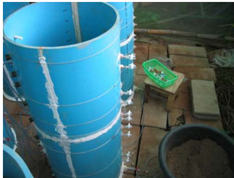
นำโมเดลท่อนบนมาประกอบติดกันด้วยใช้ซิลิโคน จากนั้นนำ filter ที่ใช้ในการเก็บตัวอย่างน้ำในดิน และ filter ที่ใช้ในการตรวจสอบค่าศักย์ความดันในแต่ละชั้นดินมาติดตั้งเข้ากับโมเดล
