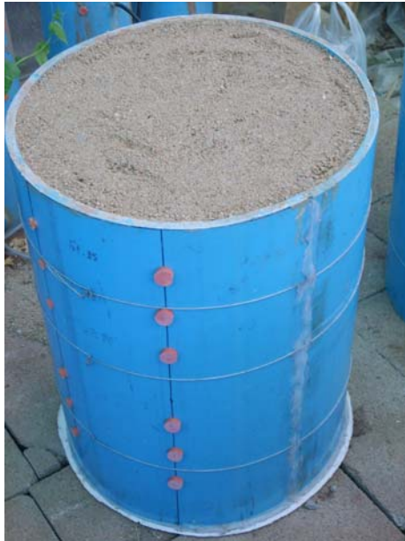
โมเดลท่อนล่างที่บรรจุทรายลงไปจนได้ระดับ 40 เซนติเมตร ตามที่ต้องการ
