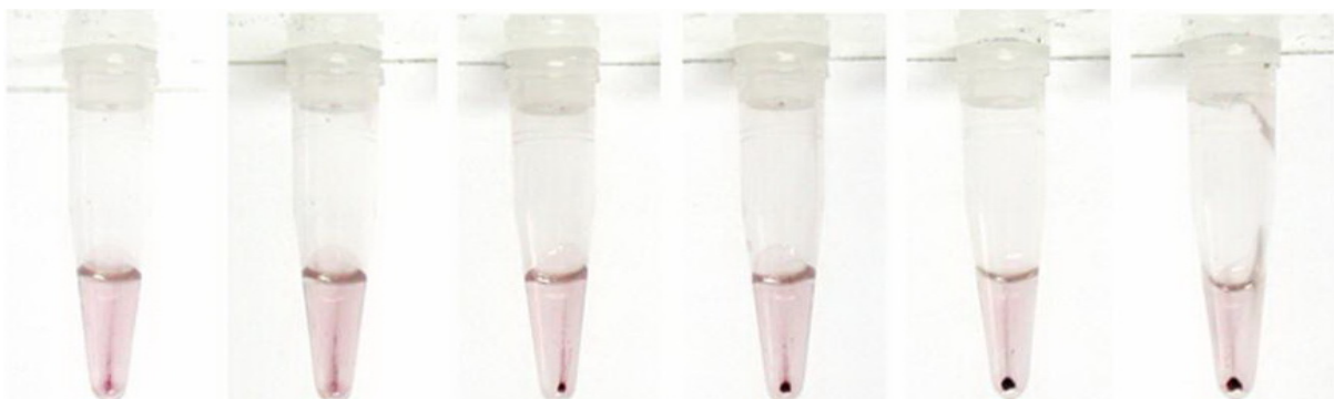
รูปที่ 1: แสดงการตกตะกอนและเปลี่ยนสีภายหลังการ centrifuge ของอนุภาคทองคำขนาดนาโนเมตร เมื่อผสมกับแอนติเจนในปริมาณ 0, 10, 10^2 , 10^3 , 10^5 และ 10^6 เซลล์/มิลลิลิตร ตามลำดับ
