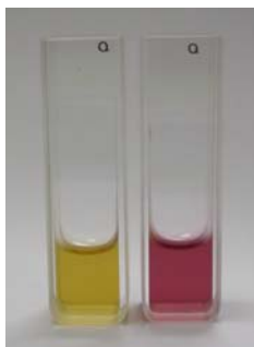
รูปที่ 4: แสดงสีของสารละลายอนุภาคเงินและทองคำตามลำดับ
