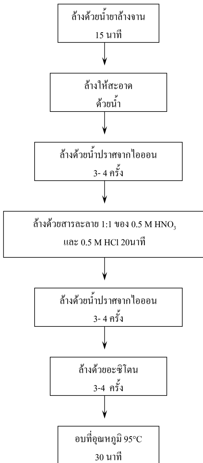
รูปที่ 3.5 แผนภาพแสดงการเตรียมวัสดุรองรับ (กระจก)
