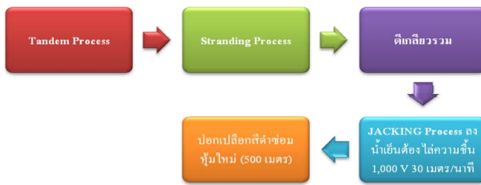
รูปที่ 56 กระบวนการผลิตสายโทรศัพท์ 100 - 300 คู่สาย ของบริษัทอีตาชีบางกอกเคเบิ้ล จำกัด
