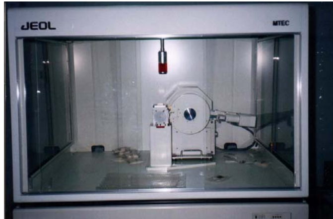
รูปที่ 3.6 เครื่อง X-ray diffractometer รุ่น JDX-8030
