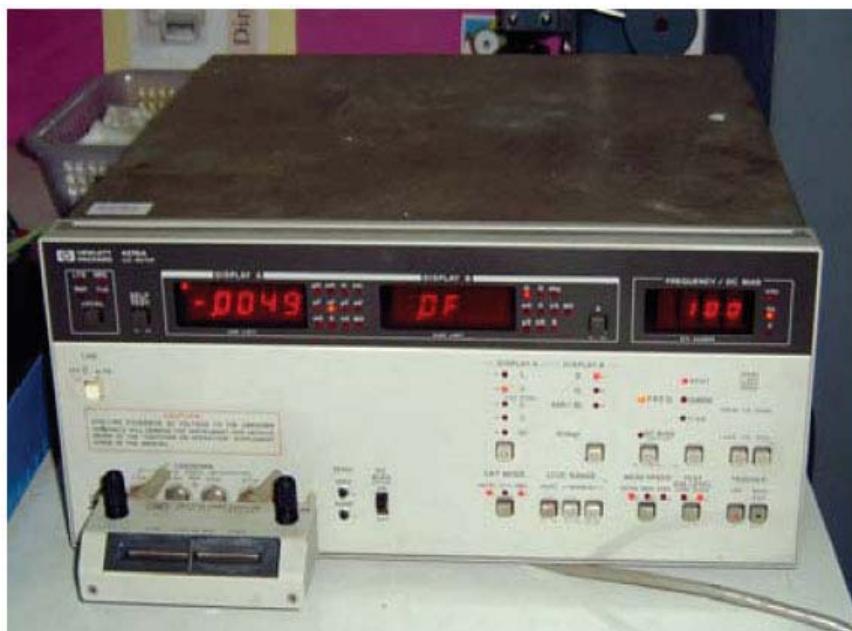
รูปที่ 3.9 เครื่อง LCR meter รุ่น HP 4276 A
