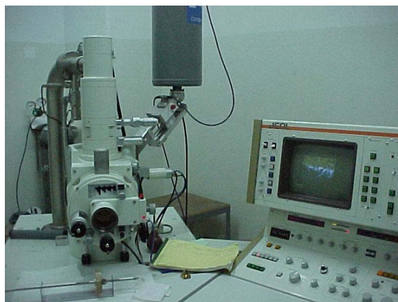
รูปที่ 3.8 กล้องจุลทรรศน์อิเล็กตรอนแบบส่องกราด (SEM) รุ่น JSM 840A
