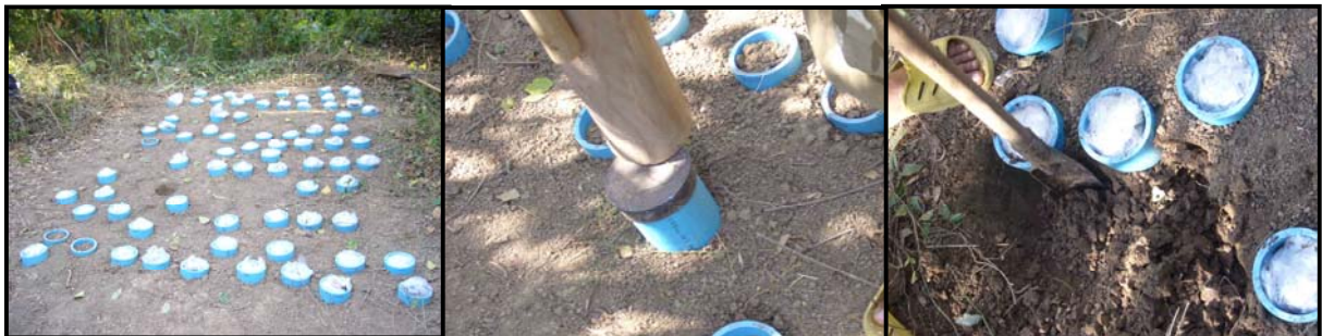
ภาพที่ 3.3 การบรรจุตัวอย่างดินแบบไม่รบกวนโครงสร้างใน Soil Microcosm
