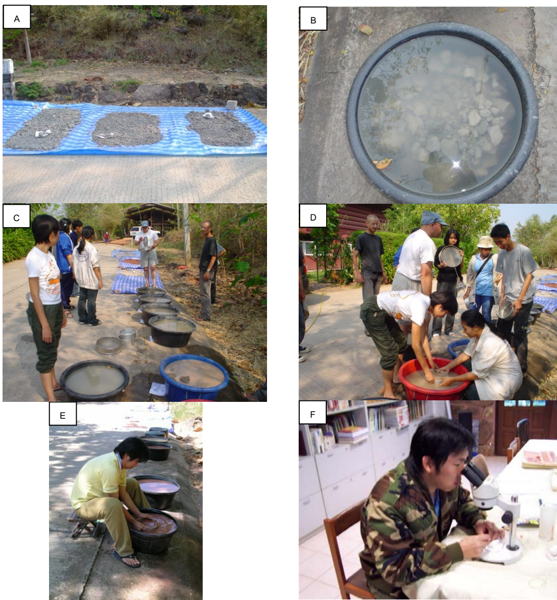
ภาพที่ 5 ลำดับขั้นตอนการร่อนตะกอนตัวอย่างซากดึกดำบรรพ์ขนาดเล็ก เริ่มจากตากตะกอนให้แห้ง (A) เทตะกอนใส่น้ำเปล่า (B) ร่อนตะกอนด้วยตะแกรงขนาดต่างๆ (C-D) และส่องตัวอย่างจากตะกอนที่คัดขนาดแล้ว (F)
