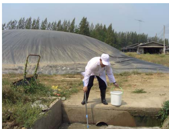
รูปที่ 31 แสดงการเก็บตัวอย่างน้ำเสีย ก่อนเข้าถังแก๊ส
