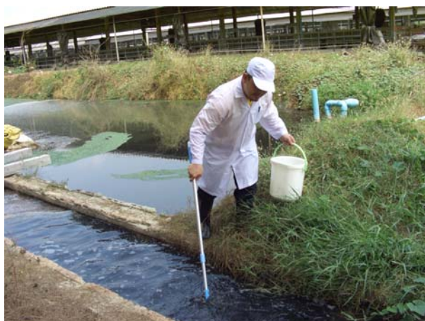
รูปที่ 32 แสดงการเก็บตัวอย่างน้ำเสีย หลังผ่านดุงแก๊ส และพร้อมปล่อยน้ำล้นออกภายนอกฟาร์ม
