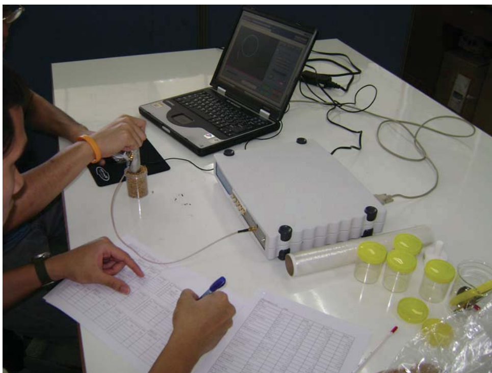
ภาพผนวกที่ 7 สาธิตการวัดค่า Dielectric properties ของข้าว
