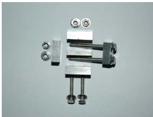
รูป 3.6 แม่แบบขึ้นรูปชิ้นงานเมื่อแยกส่วนต่างๆออกจากกัน
