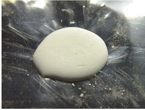
รูป 3.8 ส่วนผสมผงเซอร์โคเนียเข้ากับเซรามิกทนความร้อนและโพลีไวนิลแอลกอฮอล์
