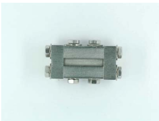
รูป 3.7 แม่แบบขึ้นรูปชิ้นงานเมื่อประกอบกันพร้อมใช้งาน
