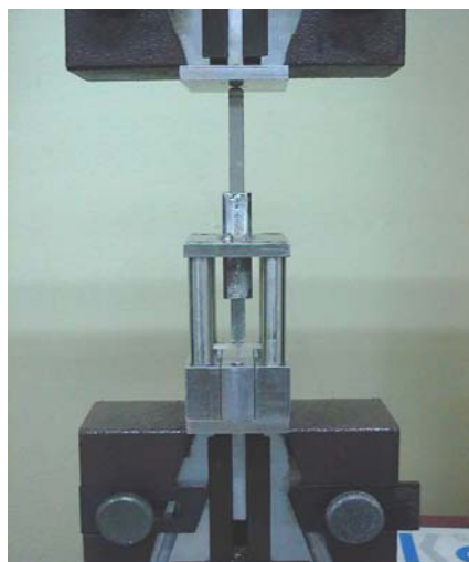
รูป 3.27 การติดตั้งเครื่องมือทดสอบแรงดัดแบบ 3 จุดที่หัวจับเครื่องทดสอบยูนิเวอร์แซล
