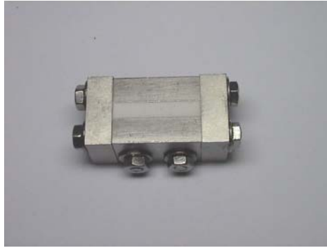
รูป 3.12 ผงแก้วภายหลังการอัดและปาดส่วนเกินออกจนเรียบขนานกับขอบของแม่แบบ
