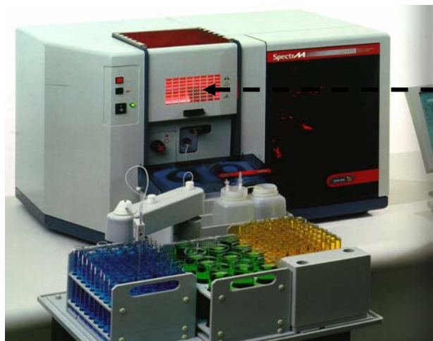
รูปที่ 1.1 เครื่อง Atomic Absorption Spectrophotometer อาศัยหลักการเกิดอะตอมอิสระ ซึ่งจะมีการจุดเปลวไฟระหว่างก๊าซอะเซทิลีนและอากาศ (ที่มา : คู่มือเครื่อง Atomic Absorption Spectrophotometer ของ VARIAN รุ่น SpectraAA 220)
