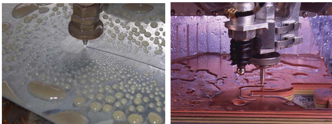
รูปที่ 2.22 Water jet cutting technology [46, 47]
