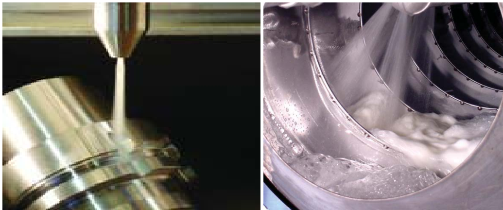
รูปที่ 2.23 Water jet cleaning technology [48]
