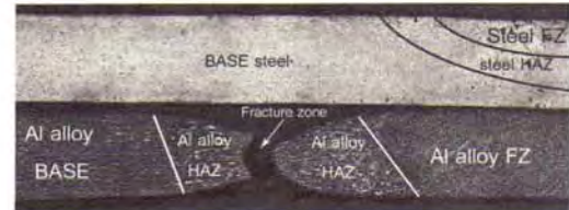
รูปที่ 11 ภาพถ่ายโครงสร้างจุลภาคบริเวณที่เกิดการแตกหักจากการทดสอบแรงดึง
