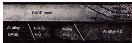
รูปที่ 9 ชิ้นงานเชื่อมที่เกิดการแตกหักบริเวณกระแทกของโลหะผสมอลูมิเนียม
