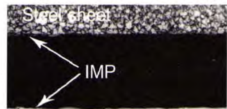
รูปที่ 8 ชิ้นงานเชื่อมที่เกิดการแตกหักบริเวณชั้นสารประกอบเชิงโลหะ
