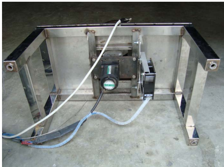
รูปที่ 23 การติดตั้งตัวกวนด้วยสนามแม่เหล็ก
