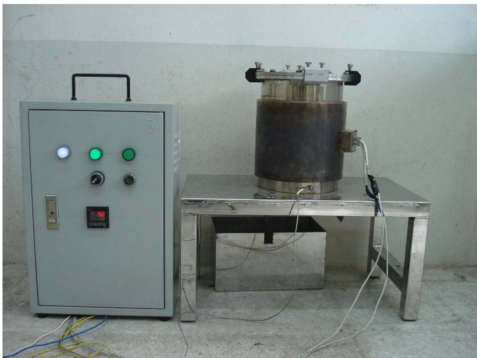
รูปที่ 21 ชุดถังปฏิกรณ์ขนาดปริมาตรประมาณ 4 ลิตร
