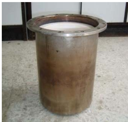
รูปที่ 25 ถังปฏิกรณ์ปริมาตร 4 ลิตรทำมาจากเทฟลอน หุ้มด้วยสแตนเลส
