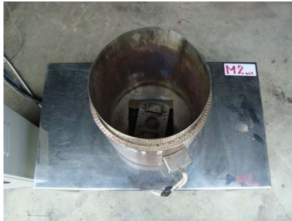
รูปที่ 24 ลักษณะตัวกวนด้วยสนามแม่เหล็ก
