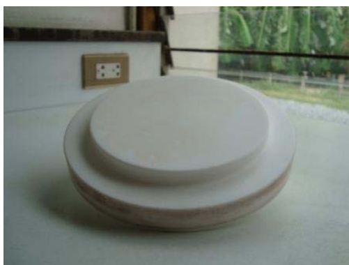
รูปที่ 25 ถังปฏิกรณ์ปริมาตร 4 ลิตรทำมาจากเทฟลอน หุ้มด้วยสแตนเลส
