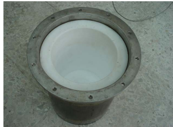
รูปที่ 25 ถังปฏิกรณ์ปริมาตร 4 ลิตรทำมาจากเทฟลอน หุ้มด้วยสแตนเลส
