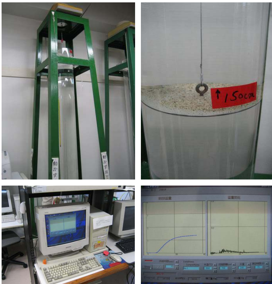
รูป ๒.๒๔ อุปกรณ์วิเคราะห์ขนาดตะกอนโดยวิธี Settling tube (สองรูปบน) ท่อพลาสติกเพื่อ หยอดตัวอย่างตะกอนสีนามิ และ (สองรูปล่าง) แสดงระบบประมวลผลคอมพิวเตอร์และ ซอฟแวร์สำหรับคำนวณขนาดและเปอร์เซ็นต์ที่ได้จากการทดสอบตัวอย่าง (ภาพโดย รศ.ดร. มนตรี ชูวงศ์)
