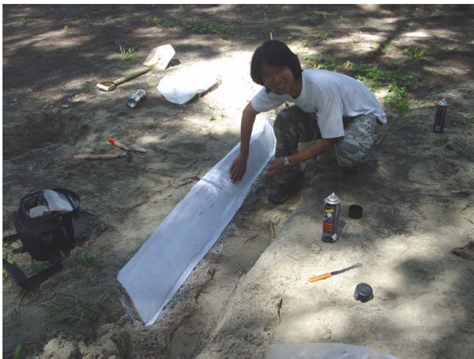
รูป ๒.๒๑ การคัดลอกตะกอนจากหน้าตัดหลุมทดสอบ (peel technique) ตัวอย่างจากบริเวณแหลมสน จังหวัดระนอง เพื่อศึกษาการกระจายตัวของชั้นตะกอนสีนํ้ามึนแนวตั้งจากกับชายหาด (ภาพโดย รศ.ดร. มนตรี ชูวงศ์)
