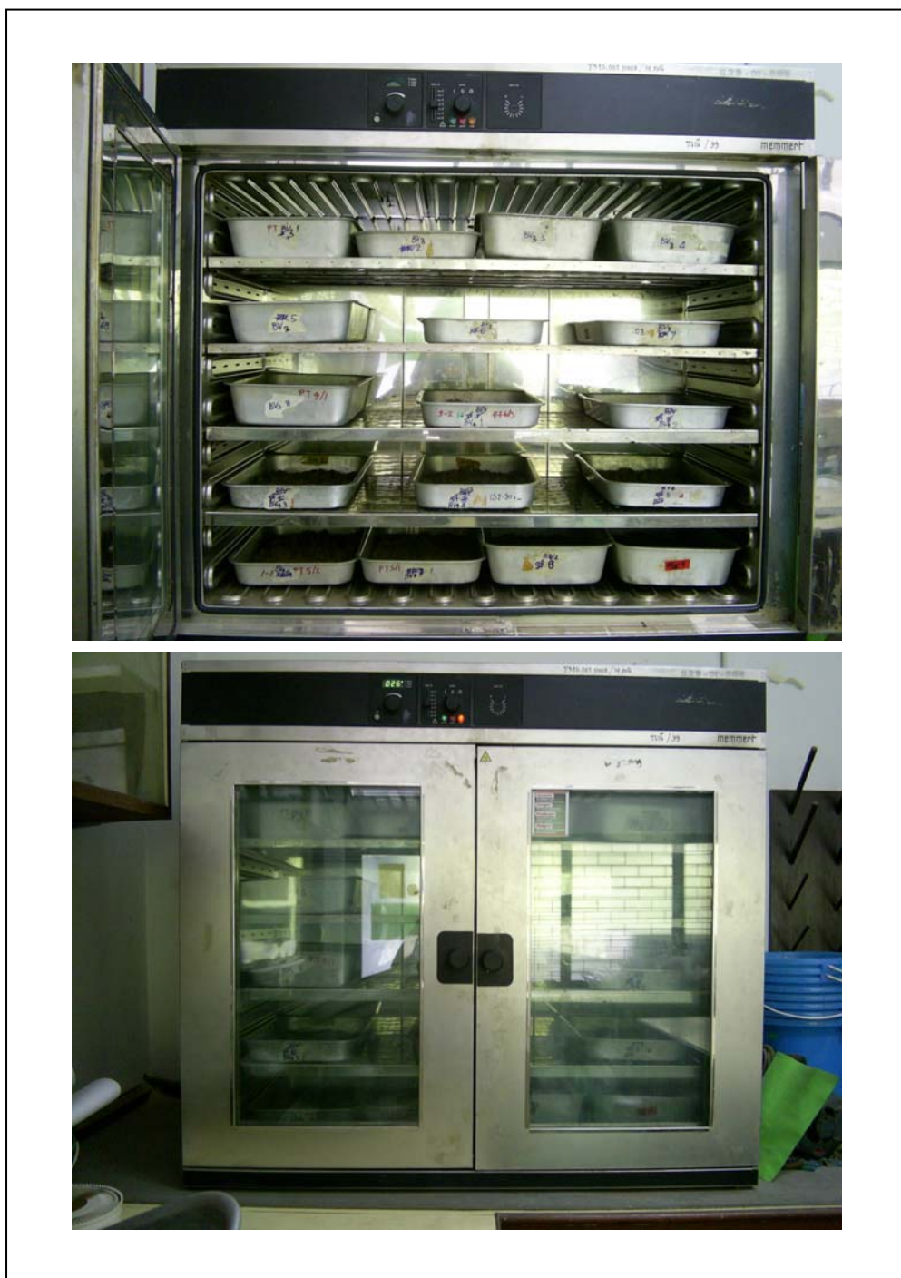
รูป ๒.๙ รูปภาพแสดงการอบตัวอย่างตะกอนภายในตู้อบที่อุณหภูมิ ๘๐ องศาเซลเซียส โดยใช้ เวลาประมาณ ๕-๖ ชั่วโมงเพื่อให้น้ำระเหยออกจากตัวอย่างตะกอนทั้งหมด (ภาพโดย สุเมธ พันธุวงศ์ราช)
