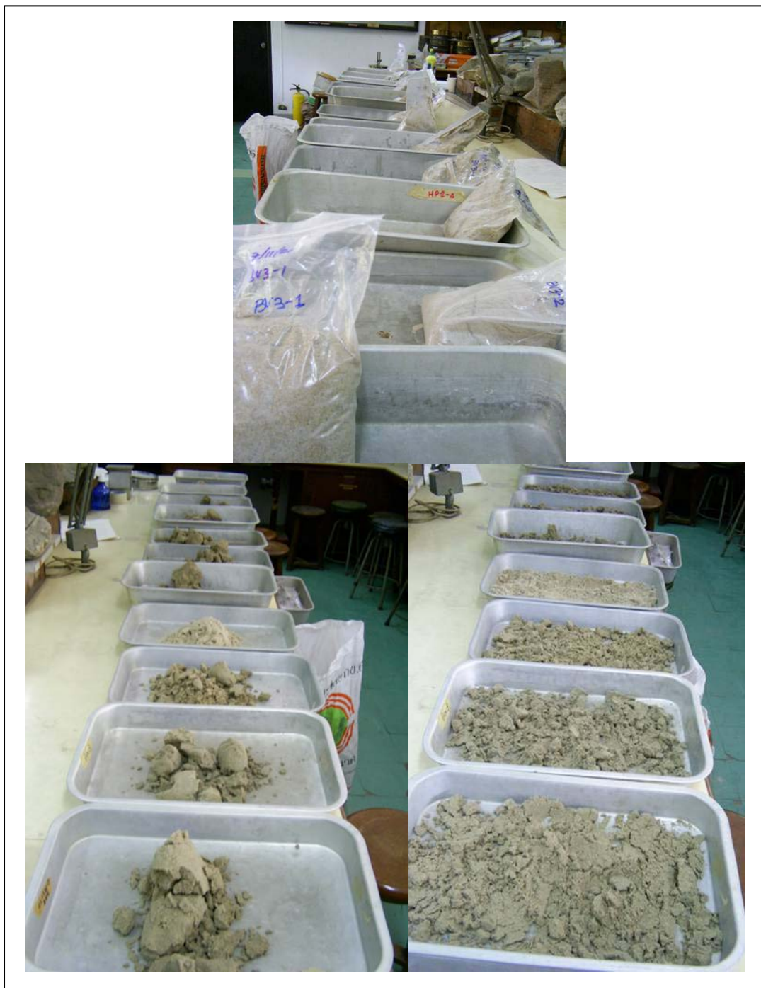
รูป ๒.๘ การเตรียมตัวอย่างตะกอนที่เก็บได้จากบริเวณหน้าหาดที่ถูกกัดเซาะจากสึนามีก่อน นำเข้าสู่อบแห้งเพื่อการวิเคราะห์ขนาดตะกอนโดย sieving test (ภาพโดย สุเมธ พันธุ วงศ์ราช)
