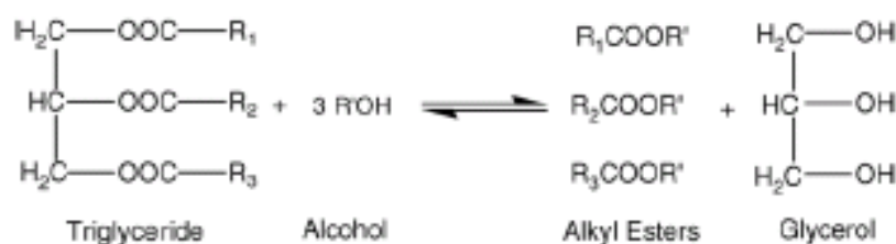
รูปที่ 1.1 ปฏิกิริยาทรานส์เอสเทอริฟิเคชันระหว่างไตรกลีเซอไรด์กับเมทานอล
