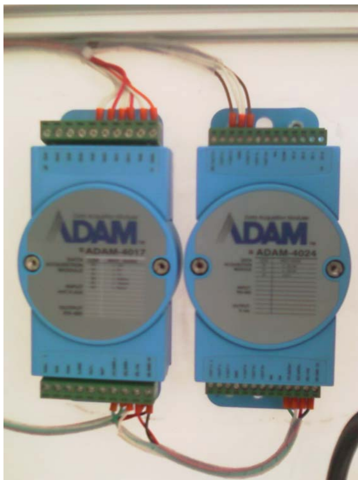
รูปที่ 4.2 รูปถ่ายของโมดูลอนาลอกอินพุตและเอาต์พุตของ Advantech
