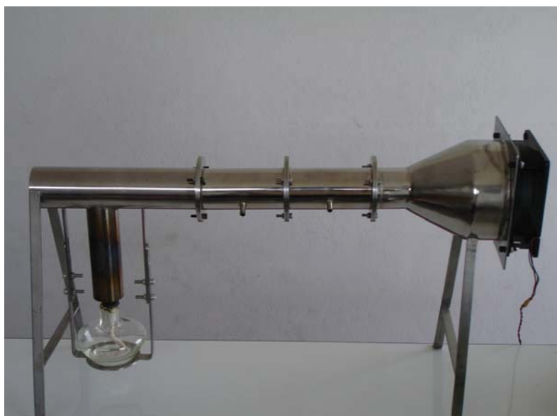
รูปที่ 5.12 รูปถ่ายของเครื่องสร้างละอองลอยที่ใช้ในการศึกษานี้ (Yawootti et al., 2010)
