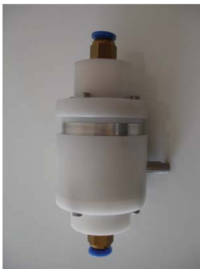
รูปที่ 3.5 รูปถ่ายของชุดดักจับไอออนที่สร้างขึ้น (Intra and Tippayawong, 2009)
