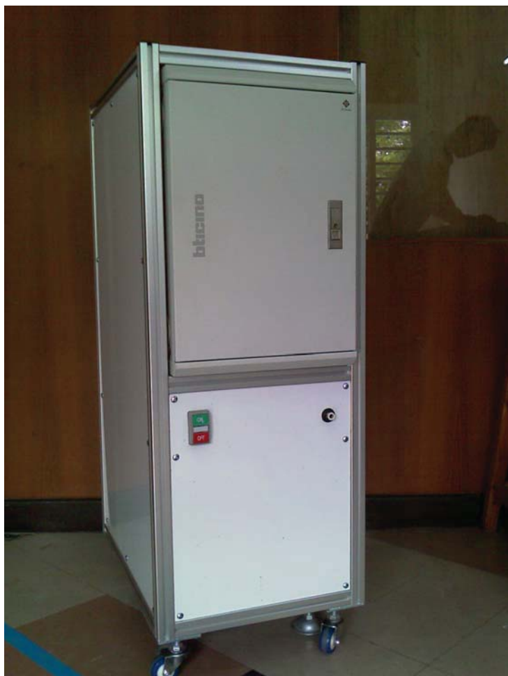
รูปที่ 5.9 เครื่องวิเคราะห์ขนาดอนุภาค (Intra and Tippayawong, 2009)
