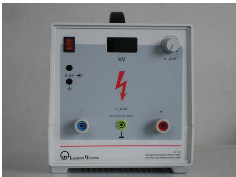
รูปที่ 5.2 รูปถ่ายของแหล่งจ่ายไฟฟ้าแรงดันสูงของ Leybold Didactic โมเดล 521721
