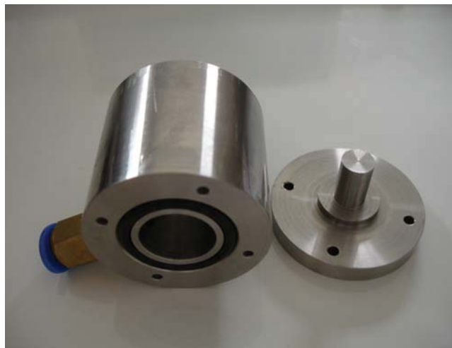
รูปที่ 3.3 รูปถ่ายของชุดคัดแยกสิ่งปนเปื้อนขนาดใหญ่ที่สร้างขึ้น (Intra, 2008)
