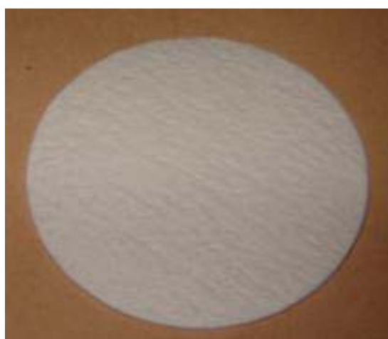
รูป 4.7 รูปถ่ายของแผ่นกรองอนุภาคประสิทธิภาพสูงแบบ HEPA
