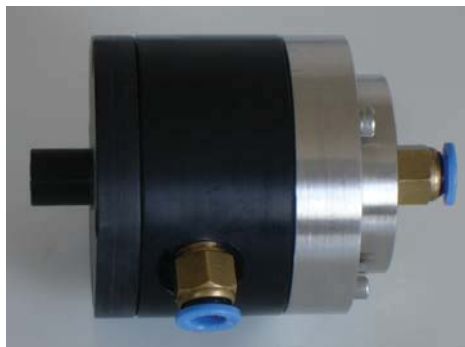
รูปที่ 3.8 รูปถ่ายของชุดให้ประจุไฟฟ้าอนุภาคที่สร้างขึ้น (Intra and Tippayawong, 2009)
