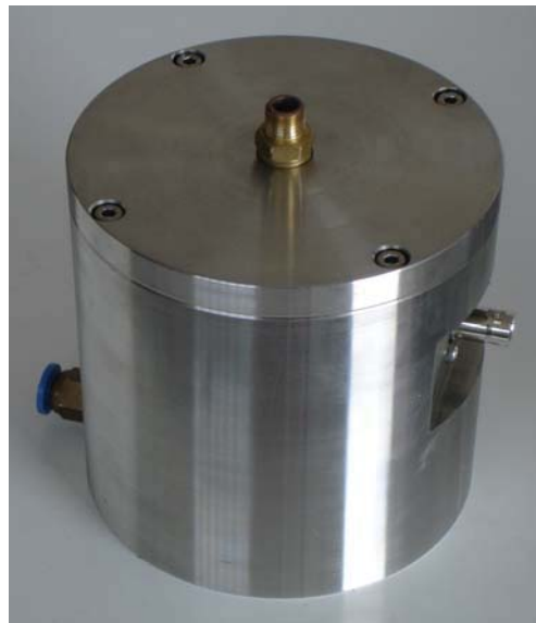
รูปที่ 3.10 รูปถ่ายของลูกถ้วยฟาราเดย์ที่สร้างขึ้น
