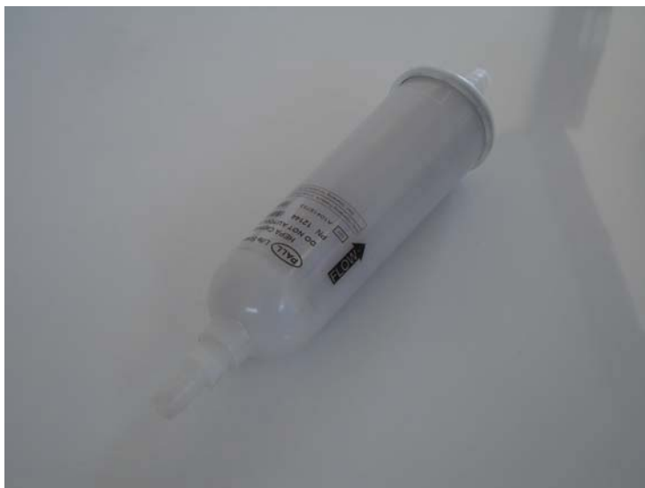
รูปที่ 5.1 รูปถ่ายของตัวกรองอนุภาคแบบ HEPA ที่ใช้ในการศึกษานี้
