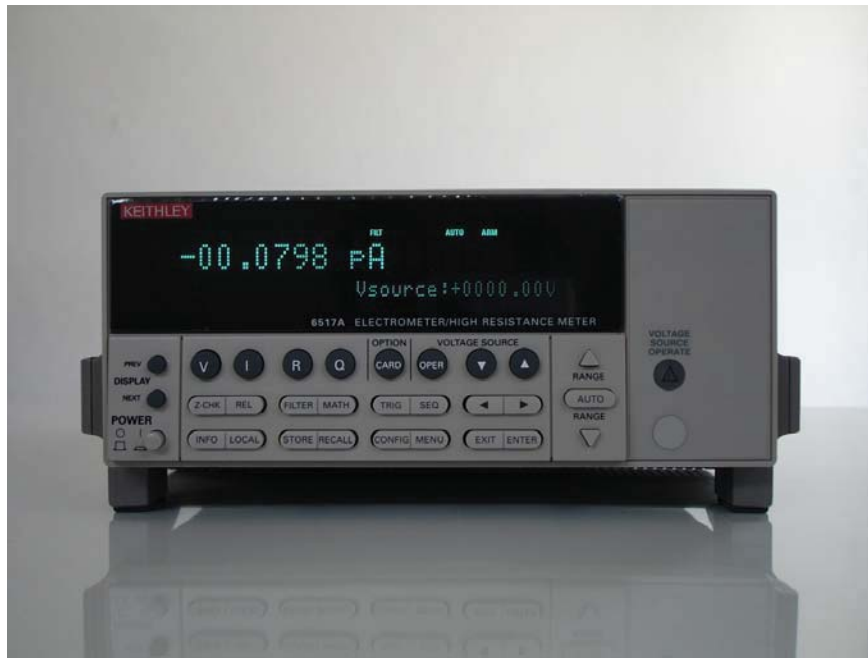
รูปที่ 5.4 รูปถ่ายของอิเล็กโทรมิเตอร์ของ Keithley โมเดล 6517A
