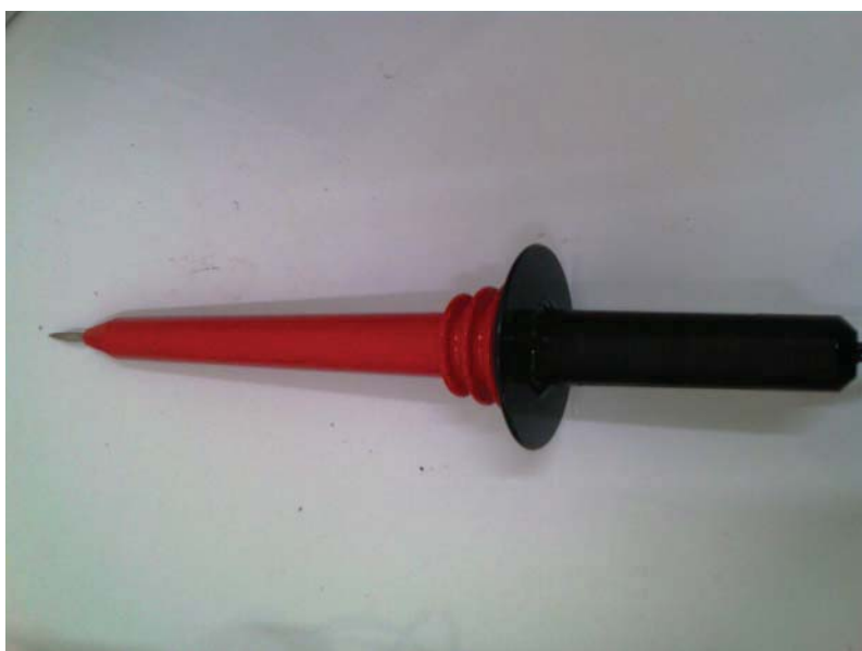
รูปที่ 5.3 หัววัดไฟฟ้าแรงดันสูงของ Fluke โมเดล 80K-40
