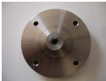
รูปที่ 6.5 รูปถ่ายของอนุภาคที่สะสมตัวบนพื้นผิวของแผ่นกระแทกภายในชุดตัดแยกสิ่งปนเปื้อน (Intra, 2008)
