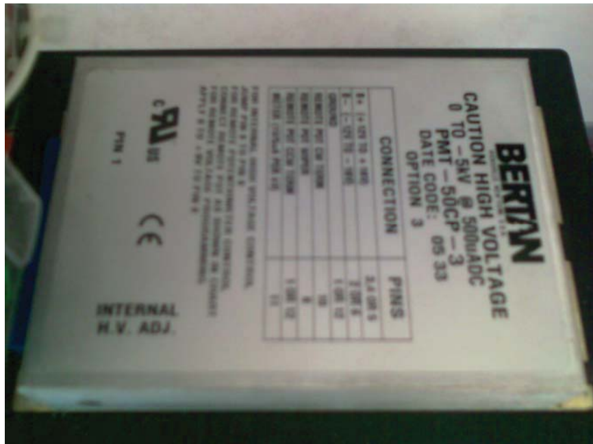
รูปที่ 4.3 รูปถ่ายของโมดูลแหล่งจ่ายไฟฟ้าแรงดันสูงโมเดล PMT-50CP
