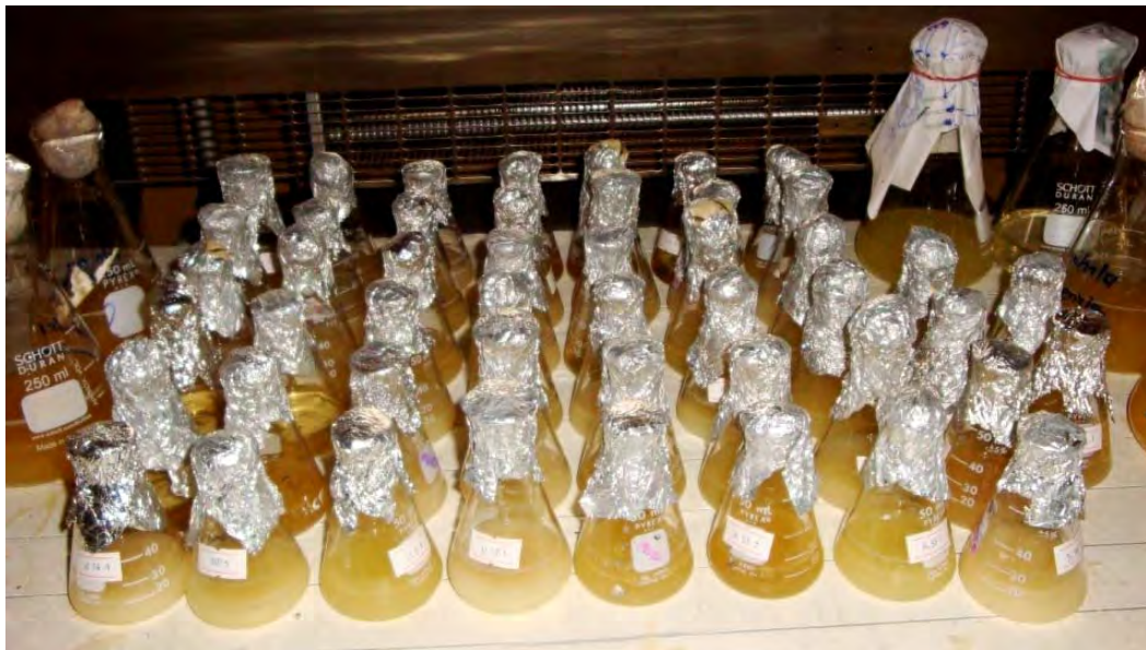
รูปที่ 4.4 การคัดเลือกยีสต์ไขมันสูง (oleaginous yeast) เบื้องต้น (primary screening) ในอาหารเลี้ยงเชื้อสูตรไนโตรเจนต่ำ (glucose 80 g/L, yeast extract 3.0 g/L, peptone 3.0 g/L, pH 5.0) ปริมาตรอาหาร 20mL ในฟลasks ขนาด 50mL บ่มแบบเขย่าที่ 30°C ที่ความเร็วรอบ 130 rpm เป็นเวลา 6 วัน
