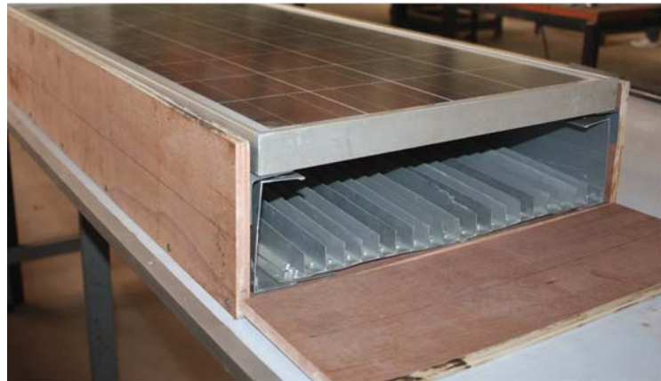
รูปที่ 2.7: แผง PV/T ที่มีครีบริบายความร้อนแบบ NFS
