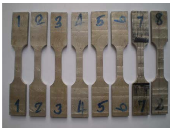
รูปที่ 1.25 ภาพแสดงชิ้นทดสอบมาตรฐานของเนื้อโลหะเดิม SSM A356
