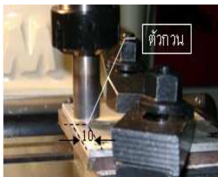
(ก) ปั่วของ Tool ห่างจากขอบชิ้นงาน 10 มม. (ข) แรงกดเริ่มต้น 450 กก. ก่อนเดินแนวเชื่อม 28 วินาที
