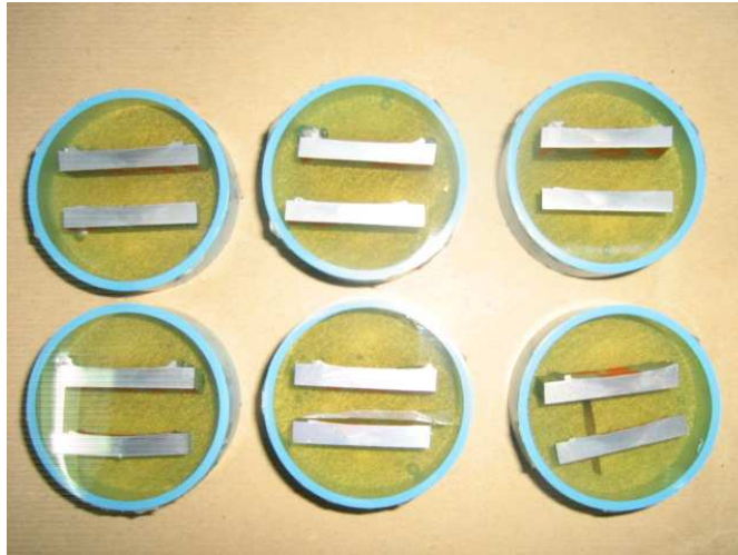
รูปที่ 1.16 แสดงชิ้นงานที่เคลือบด้วยน้ำยา Epoxy
