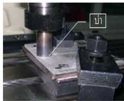
(ก) ปั่วของ Tool ห่างจากขอบชิ้นงาน 10 มม. (ข) แรงกดเริ่มต้น 450 กก. ก่อนเดินแนวเชื่อม 28 วินาที
