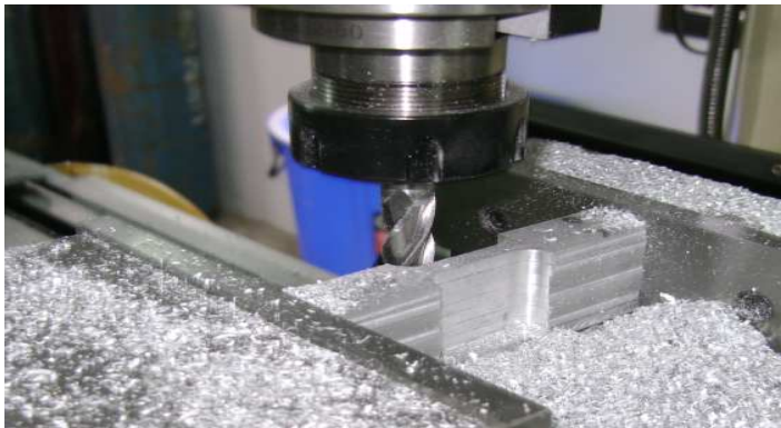
รูปที่ 1.24 ภาพแสดงการขึ้นรูปชิ้นทดสอบแรงดึงของเนื้อโลหะเดิม
