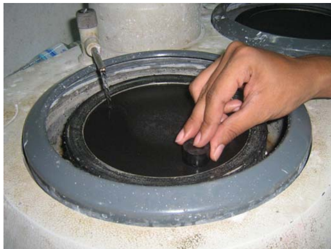
รูปที่ 1.17 แสดงการเตรียมชิ้นงานเพื่อตรวจสอบโครงสร้างทางโลหะวิทยา
