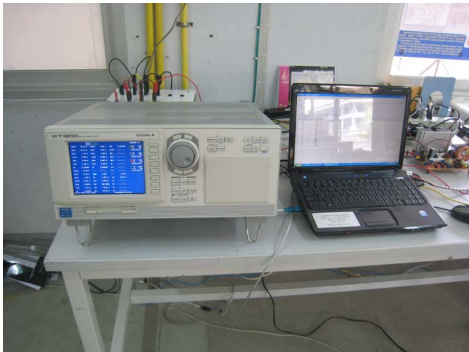
ภาพที่ 2 การทดสอบสมรรถนะของระบบเครื่องแปลงผันแรงดันไฟฟ้ากระแสสลับเป็นแรงดันไฟฟ้ากระแสตรงชนิด 3 เฟส ที่ใช้โมดูลวงจรเรียงกระแสแบบซุก ชนิด 1 เฟส จำนวน 3 โมดูล ที่ระบบใช้ตัวเก็บประจุที่บัสแรงดันไฟฟ้ากระแสตรงขนาด 470 \mu F โดยใช้ Digital Power Meter ชนิด 3 เฟส รุ่น WT1600
