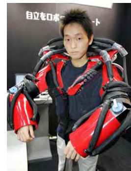
(ค) ชุดที่ช่วยในการเคลื่อนไหวสำหรับผู้สูงอายุและคนพิการสามารถพับและงอข้อศอก อีกทั้งยังสามารถบิดเข้าหาและออกนอกลำตัวได้
