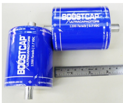
ภาพที่ 1-27 ชุดเปอร์คาปาซิเตอร์ของบริษัท Maxwell (เรียกว่า Booscap) 1 เซลล์ และโมดูลที่ BCAP1200 ต่ออนุกรมกัน 12 ตัว
