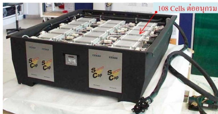
ภาพที่ 1-26 ชุดเปอร์คาปาซิเตอร์ของบริษัท SAFT โมดูลขนาดใหญ่ 108 ตัว ต่ออนุกรมกัน
